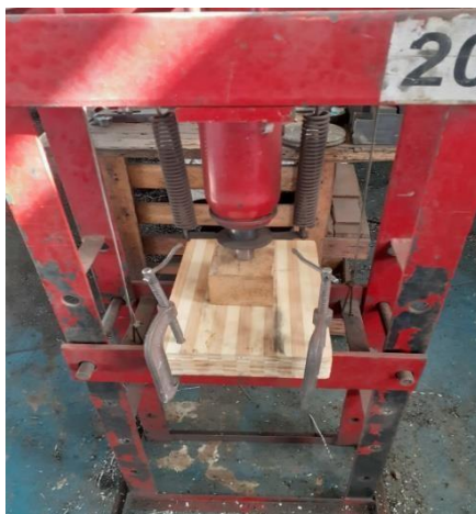
Figura 3 - Processo de colagem do bloco de bambu.
