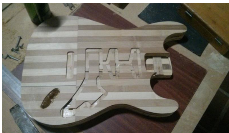
Figura 6 - Usinagem dos detalhes.
